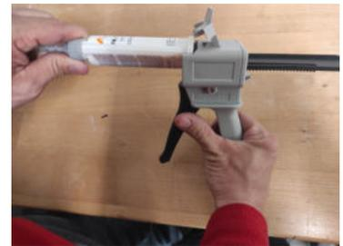
Hebel auf Kartusche öffnen, die Kartusche einsetzen und den Hebel wieder schließen
