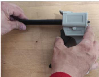
Hebel nach oben Drücken und Kartuschenstab in die Führung schieben
