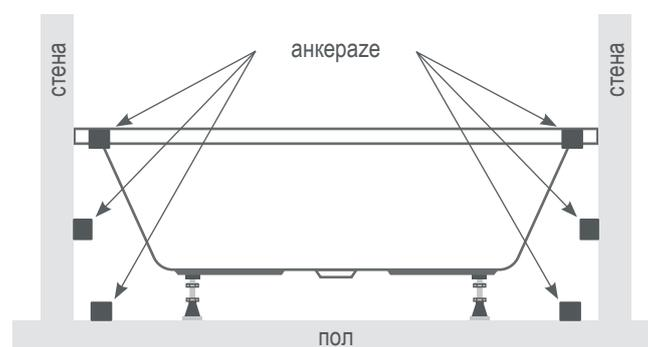
После полного высыхания клея задвинуть панель дизайнерской облицовки под ванну до попадания в анкера. Заполнить стык между ванной и панелью силиконом.
