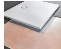
Abdichtnorm 18534-1 wird perfekt eingehalten: Sanitäracryl unterliegt laut Norm keiner Wassereinwirkklasse und somit ist nur die Abdichtung zu Wand und Boden nötig. Dieser Dichtvlies ist bei „davis“ bereits integriert. Damit entfällt die vollflächige Abdichtung unter der kompletten Duschwanne.
